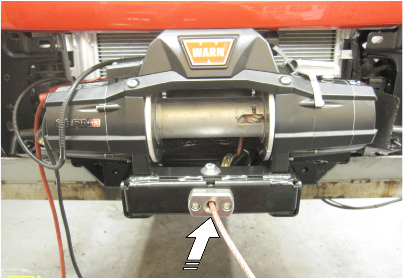
11 Seil einführen und Seilwinde anschließen! Insert the rope and connect the winch!
